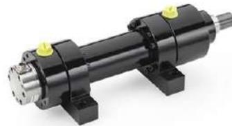
Die **Baureihe CCT** ist mit einem **magnetostriktiven Wegmesssystem** ausgestattet und sie wird nach **ISO 6022** gefertigt. Die kompakte Konstruktion mit runden Zylinderköpfen ist für die anspruchsvollsten Anwendungen in der Stahlindustrie mit kontinuierlichem Nenndruck bis **25 MPa** geeignet.
