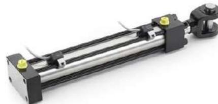
Die **Baureihe CHM** entspringt aus der Baureihe CH und sie ist mit regulierbaren **Induktivsensoren** ausgestattet. Der kompakte Bau nach **ISO 6020/2** und **DIN 24554** mit Zylinderköpfen (quadratisch) und Zugankern ist für jede industrielle Anwendung mit einem Nenndruck bis **12 MPa** geeignet.
