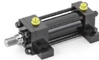
Die **Baureihe CH** wird nach den internationalen Standards **ISO 6020/2** und **DIN 24554** gebaut. Die kompakte Konstruktion mit Zylinderköpfen (quadratisch) und mit **Zugankern** ist für jede industrielle Anwendung mit kontinuierlichem Nenndruck bis **16 MPa** geeignet.
